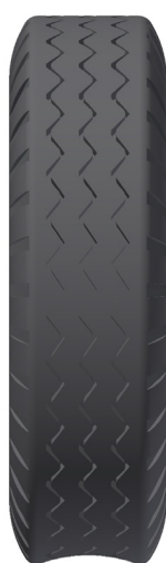
Falta de pressão
